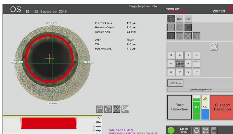
Рисунок 8 – Интерфейс фемтосекундного лазера (после аппланации на роговицу пациента) для центрации и позиционирования зоны фемторезекции роговицы
