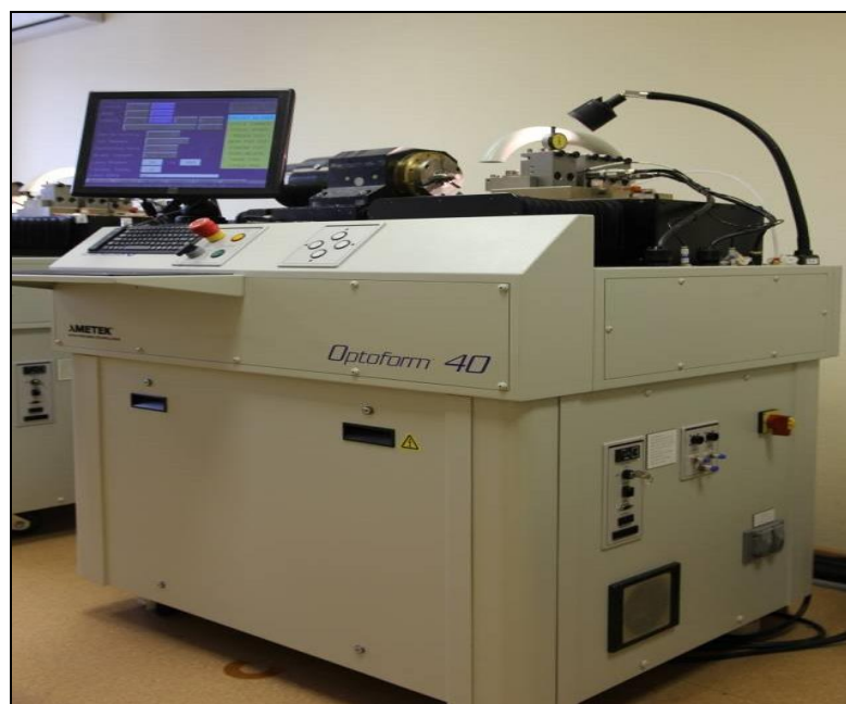
Рисунок 61 – Прецизионный станок с числовым программным управлением «Optoform 40» (Sterling Ultra Precision, США)
