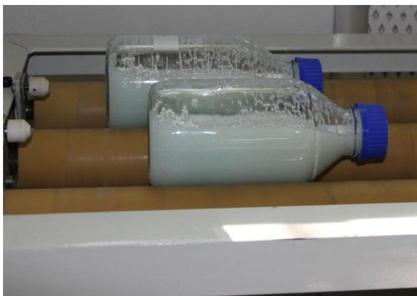
Рисунок 62 – Процесс полировки искусственного хрусталика глаза МЕТОДОМ ГАЛТОВКИ
