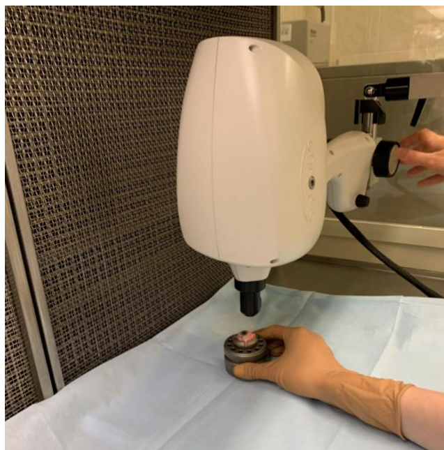
Рисунок 10 – Выполнение оптической когерентной томографии роговицы на изолированном кадаверном глазе животного
