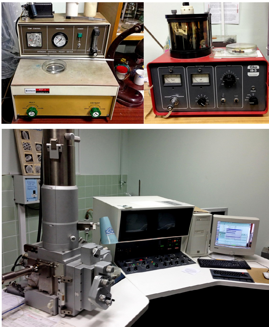
Рисунок 2.1 – Оборудование для электронной микроскопии: барокамера (сверху слева), ионно-распылительная установка (сверху справа), сканирующий электронный микроскоп (снизу)
