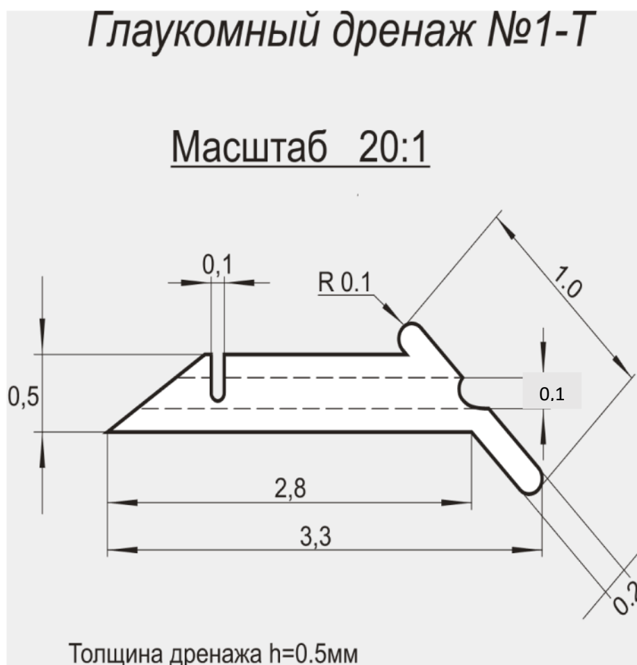
Рисунок 3 – Конструкция полимерного микрошунта Репер-НН
