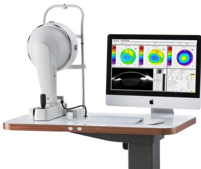
Рисунок 2 — Внешний вид ротационной Шаймпфлюг-камеры (Pentacam HR, OculusOptikgeräte GmbH, Wetzlar, Germany) с компьютерным модулем
