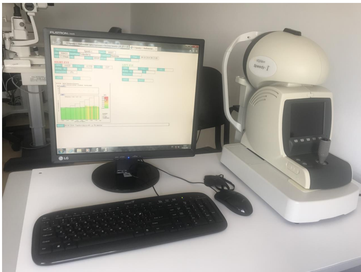
Рисунок 3 - Авторефрактометр Righton Speedy-I, Япония
