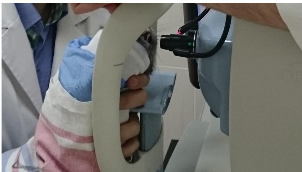
Рисунок 9 – Процесс выполнения оптической когерентной томографии роговицы кролика в ходе эксперимента in vivo на томографе OPTOVUE RTVue-100 (США)
